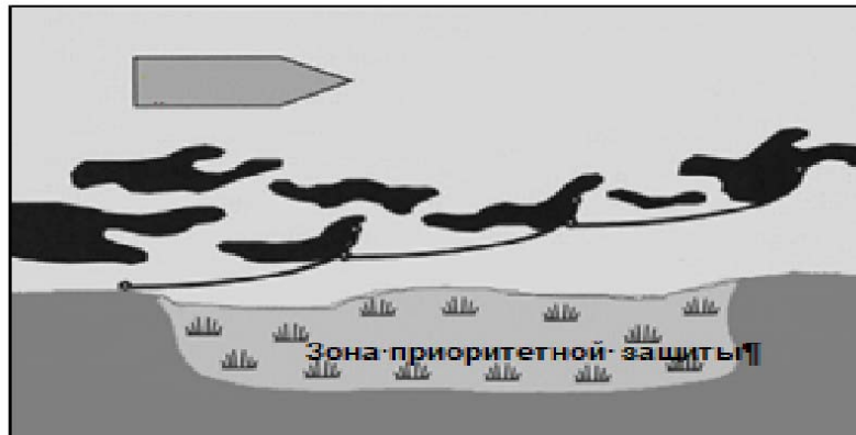
Рисунок 6.6 – Отвод нефтяных пятен бонами, установленными каскадами
