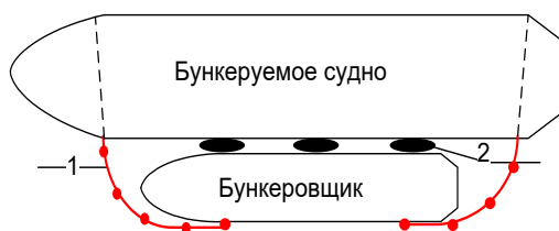
Рисунок 3.4. Ограждение бонами судов при бункеровке в акватории
