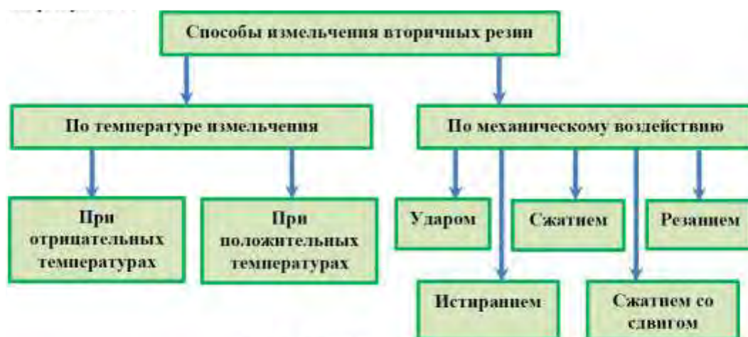
Рисунок 3.1- Способы измельчения шин и покрышек
