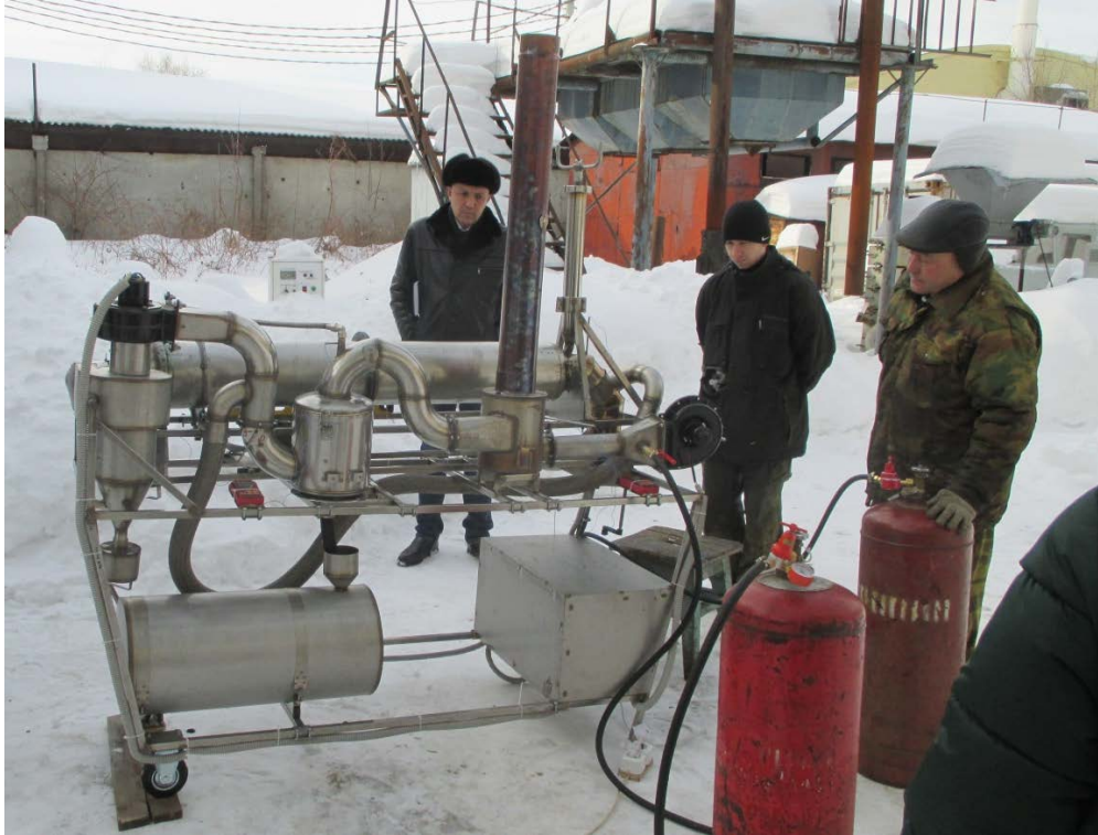
Фото 4.1.1 – Экспериментальная установка моделирования технологического процесса термомеханической обработки ОСВ (ООО «КАИ-ПЛАМЯ», февраль 2019 г.)
