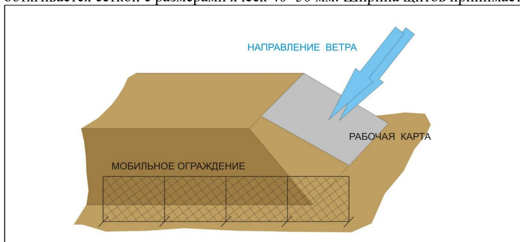
Рисунок 1.1.5 - Расположение ограждений в соответствии с направлением ветра
