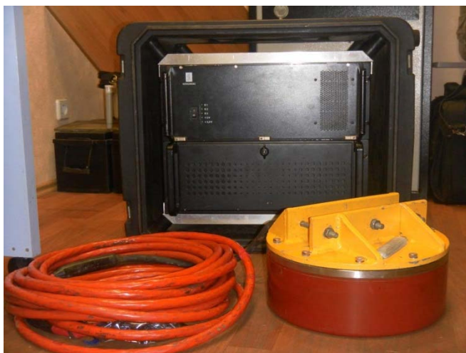
Рисунок 5 – АГК на базе МЛЭ Kongsberg EM 3002
