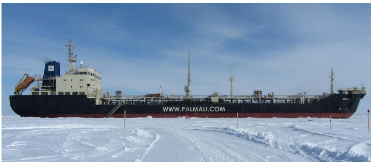
Рисунок 3.4. Нефтеналивной танкер класса Arc5 «Лагорта»
