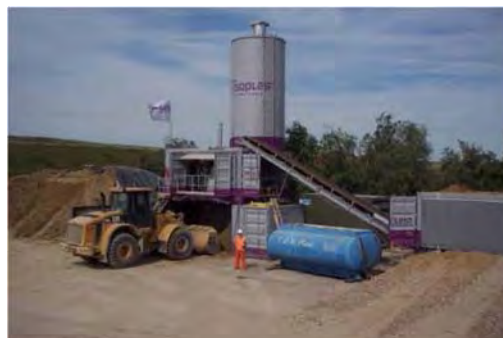
Чертеж №1. Передвижная установка для приготовления гидроизоляционной смеси.
