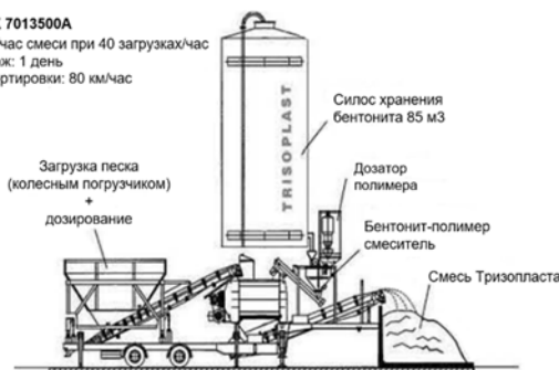
Чертеж №1. Передвижная установка для приготовления гидроизоляционной смеси.
