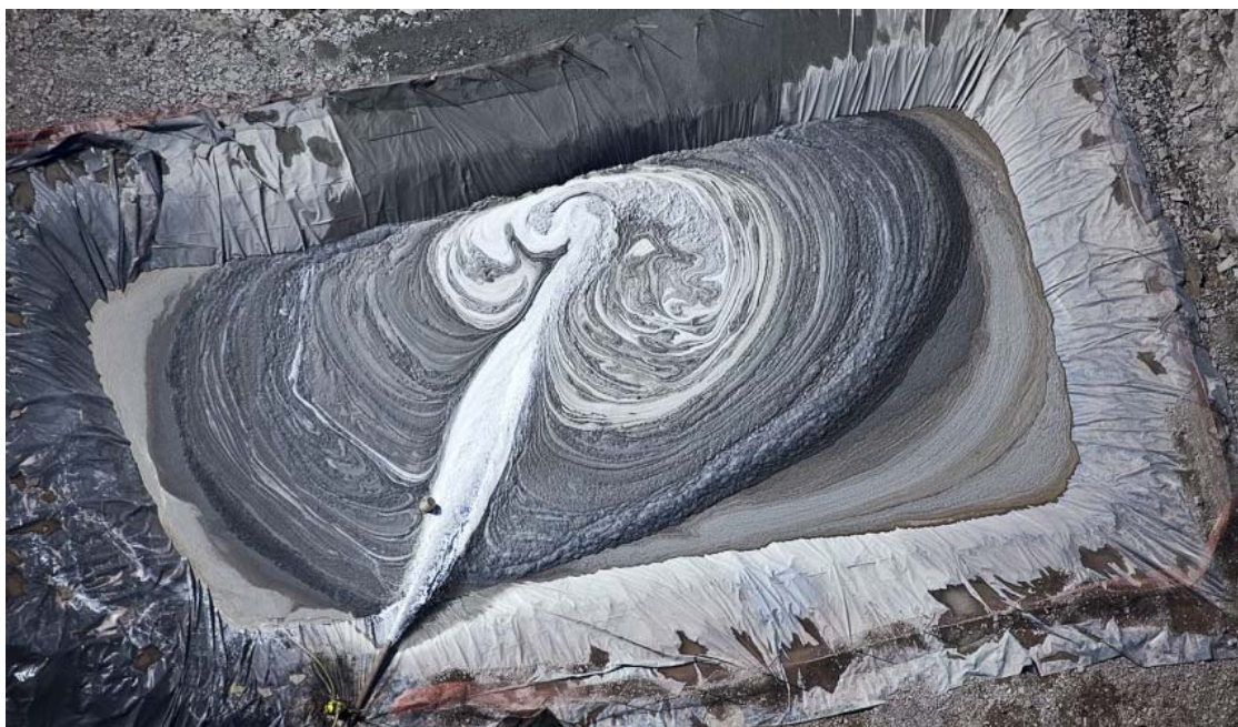
Рисунок 7.17 – Буровые отходы – шлам, отработанный буровой раствор в гидроизолированном амбаре
