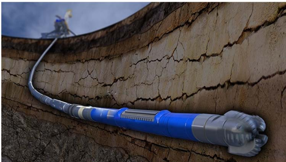
Рисунок 7.16 – Бурение наклонно-направленной скважины
