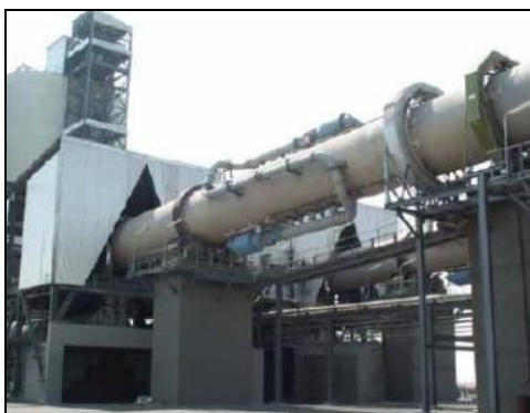
Рисунок 5.1.1.2-1. Печь прокали кокса; холодильник; камера дожигания: фирма FL-Smith (Канада)
