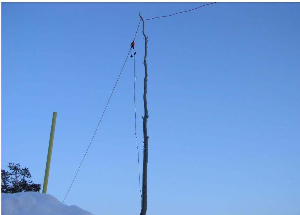
Рисунок 2.3. Прокладка сейсмокос с помощью шестов в местах пересечения профилей
