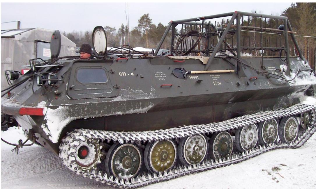
**Рисунок 2.2. Вездеход, используемый для смотки-размотки сейсмоко**
