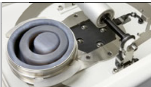
Прижимающие детали для автоматического подъема размольной гарнитуры и предохранительный выключатель, проверяющий глухую посадку.
